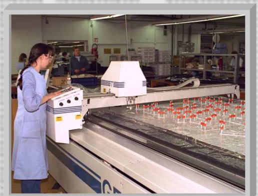
der Zuschchnitt kann manuell oder mit einem Cutter erfolgen
