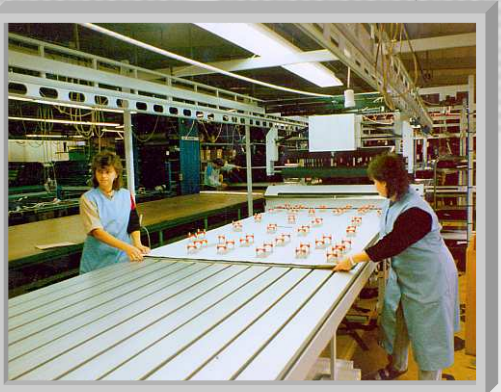
das fertige Lagenpaket wird durch VEITH-Stofflagenhalter fixiert
