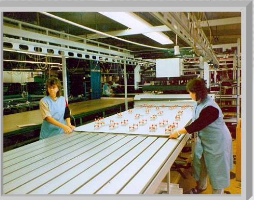
das fertige Lagenpaket wird durch VEITH-Stofflagenhalter fixiert
