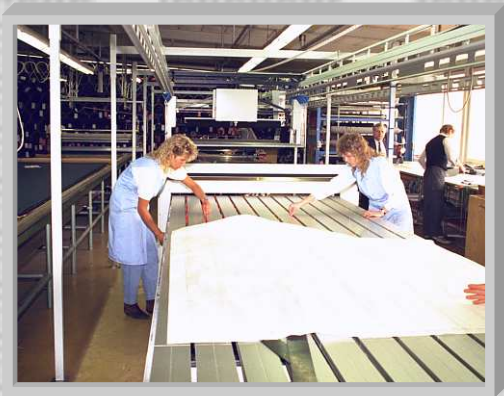
die Nadelreihen werden entsprechend dem Lagenbild eingestellt
