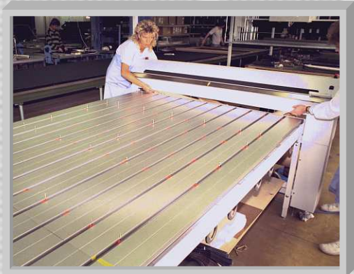
jede Nadel kann unabhängig ein- und ausgeschaltet werden
