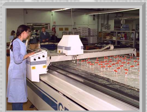
der Zuschchnitt kann manuell oder mit einem Cutter erfolgen
