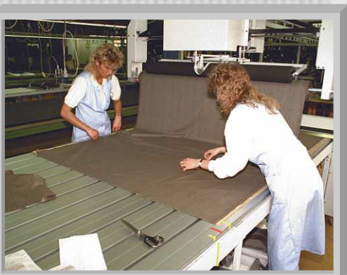
Legen und Abrichten des Stoffs in einem Arbeitsgang
