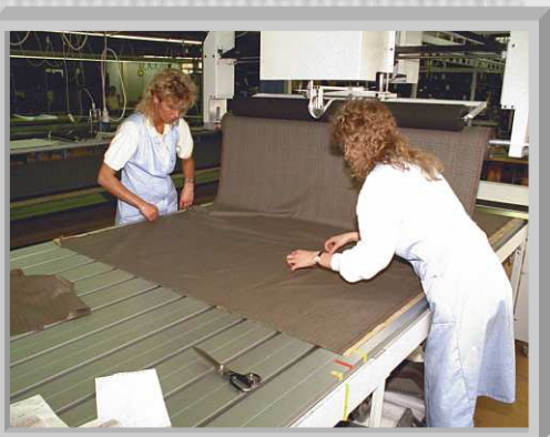
Spanuitul si indreptarea tesaturii se fac printr-o singura operatie
