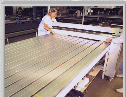
Fiecare ac poate fi blocat / deblocat independent
