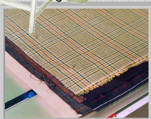
Deseori pot fi spanuite chiar stofe diferite in cadrul aceluasi span.
