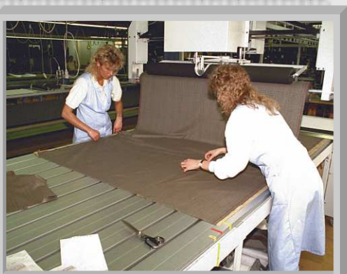
stendere e piazzare il tessuto in una sola fase di lavoro
