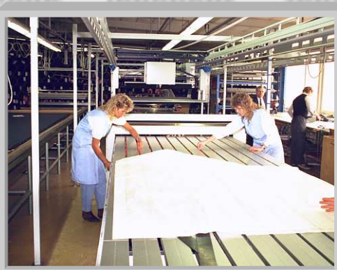
le barre ad aghi vengono disposte e posizionate secondo il modello
