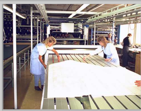
le barre ad aghi vengono disposte e posizionate secondo il modello
