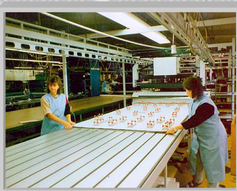
il materasso di tessuto viene fissato con il sistema a di ponti ad aghi VEITH STOLK
