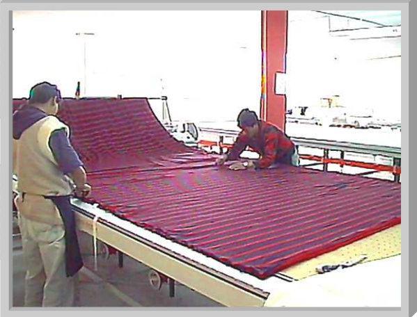
stesura del tessuto a seconda della posizione degli aghi
