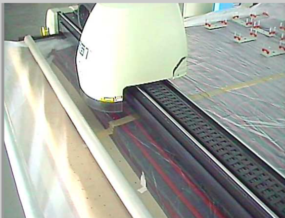
taglio del materasso di tessuto a maglia con taglio automatico
