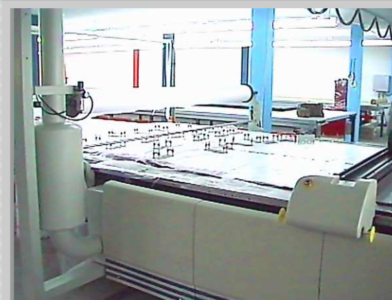
il materasso viene poi posizionato per il taglio
