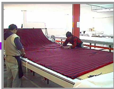
stesura e piazzamento
