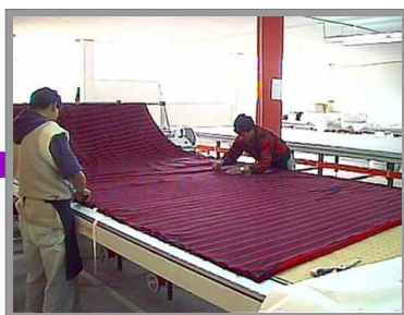
stesura e piazzamento
